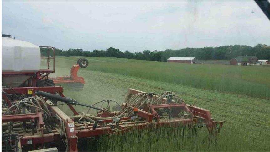
*Semis et roulage simultané chez Mark. Son semoir en 39 rangs est équipé de disques gaufrés pour ouvrir le couvert juste avant son roulage.*
