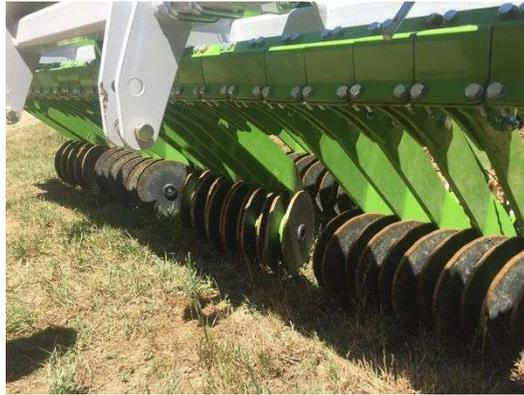
La « désherbeuse » à disque Orbis permet un désherbage entre les rangs sans travail du sol grâce à un effet de lacération du végétal par le passage de doubles disques.
