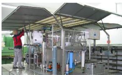
Figure 1: ligne mobile d'embouteillage de jus de fruits
